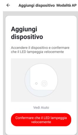
E' possibile abbinare anche il dispositivo tramite la "Modalità AP", premere il tasto in alto a destra, premere il tasto "TIMER" per cinque secondi circa: si
